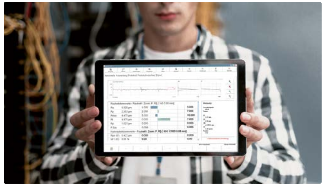
Ausschnitt aus der Option „RoughnessPlus“. Virtuelle Lineale zum interaktiven Festlegen von Abständen in X- und Z-Richtung im Profelfeld
