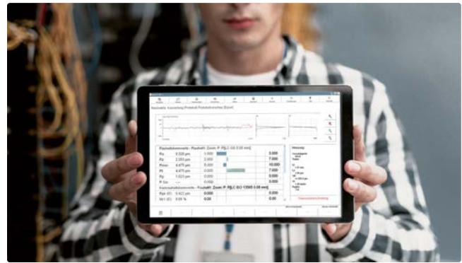
Extracto de la opción «RoughnessPlus». Reglas virtuales para el establecimiento interactivo de distancias en las direcciones X y Z en el campo del perfil.
